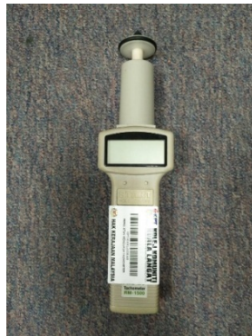
Rajah 2.1: Tachometer untuk mengukur kelajuan sebuah motor
