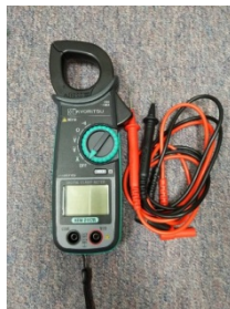
Rajah 2.2: Clamp Meter menyukat nilai Voltan dan Arus
