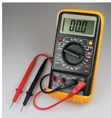
Rajah 2.3 : Multimeter mengukur penebatan dan keterusan litar kawalan
